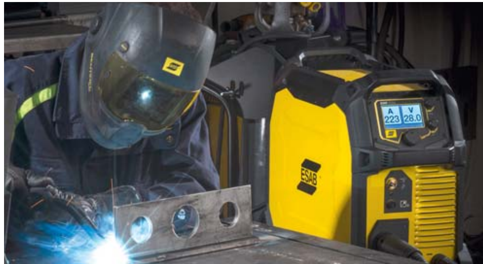
Mit der Rebel EMP 255ic und der Rebel EMP 320ic profitieren Anwender von der Produktivitätssteigerung beim Sprühlichtbogenschweißen mit hoher Einschaltdauer.
