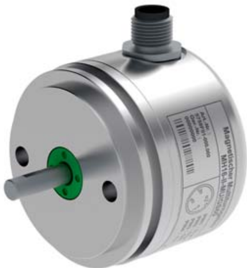
Der kompakte, kostengünstige Multiturn-Drehgeber MH64-II-CAN(MU) eignet sich auch zur Winkelerfassung in sicherheitsrelevanten Anwendungen der Kategorie PLd. Bild: FSG
