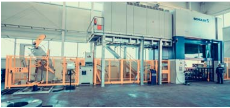
Auf der neuen MSD 630 von Schuler produziert Plasmet Ziehteile mittlerer Größe mit einer Blechdicke von 0,5 bis 6 mm.
