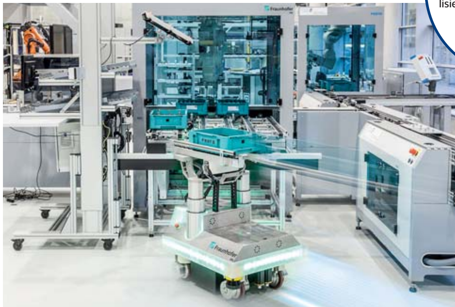
Die Cloud-basierte Navigationstechnologie, entwickelt am Fraunhofer IPA, macht den Einsatz von fahrerlosen Transportsystemen verlässlicher, flexibler und effizienter.
