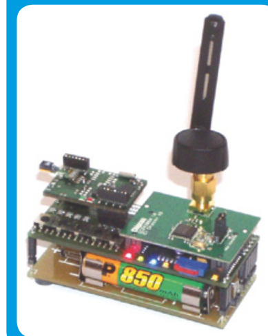
Vom MCB entwickelter Sensor-knoten zur drahtlosen Übertragung von Messwerten innerhalb des Containers. Derzeit stehen Module für Temperatur, Feuchtigkeit, Licht und Erschütterungen zur Verfügung.
