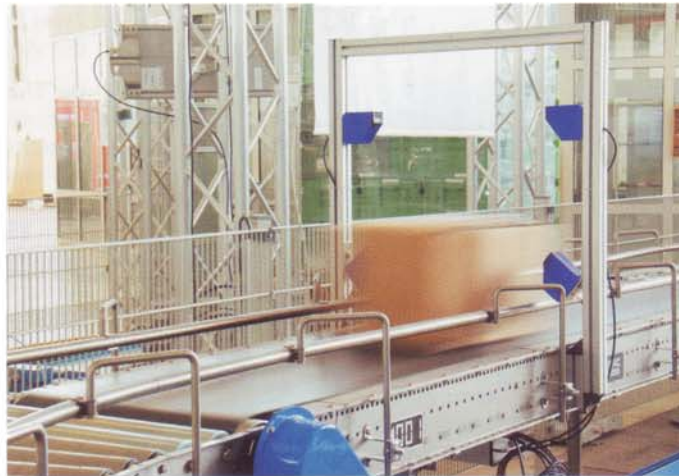
Scannerdusche auf der Fördertechnikanlage mit Sortierfunktion vor dem neuen AKL (Bilder: BIBA)
