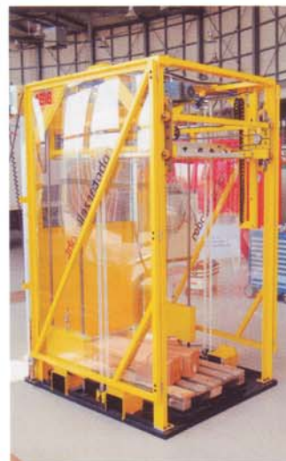
Vielseitige Depalettierungsmöglichkeiten bietet die „Roboterzelle Light“
